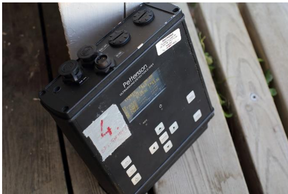
Figur 30. En automatisk ultraljudsdetektor typ D-500X kan användas för att dokumentera förekomst av brunlångöra både inne i och utanför kyrkan.
